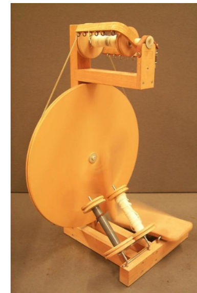
Vervaardiger Louet (Lochem) Plaats Lochem Datering 1960 - 1969 Objectnummer 09794 Objectnaam spingereedschap, spinnewiel, vleugelspinnewiel Materiaal hout Deelcollectie industrieel erfgoed, techniek Afmeting hoogte: 75.0 cm, breedte: 50.0 cm, lengte: 34.0 cm
